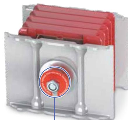
TUERCA DE DOBLE CABEZA QUE SE DEGÜELLA CUANDO SE ALCANZA EL TORQUE NOMINAL DE 85NM DURANTE LA PRIMERA INSTALACIÓN
