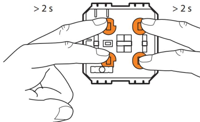
Ajuste del mínimo y máximo de iluminación, recomendado en el caso de que la lámpara parpadee en funcionamiento mínimo y máximo del variador. (Antes de realizar los ajustes, deje que se establezca la iluminación dejando la lámpara encendida unos segundos).
