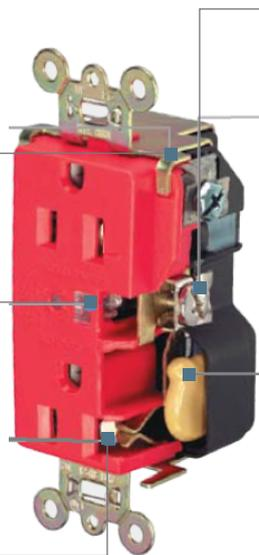
Tornillos laterales con placa interna y externa (incluyendo el tornillo de puesta a tierra) que acepta cables de 2,082 mm<sup>2</sup> (14 AWG) a 5,260 mm<sup>2</sup> (10 AWG) permitiendo dos conductores sobre la misma terminal.
